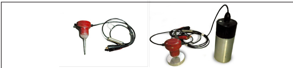
Figura 5.2: Geófonos que pueden ser fijados al suelo (izquierda), o que pueden ser apoyados sobre el suelo o alguna superficie rígida (derecha).
