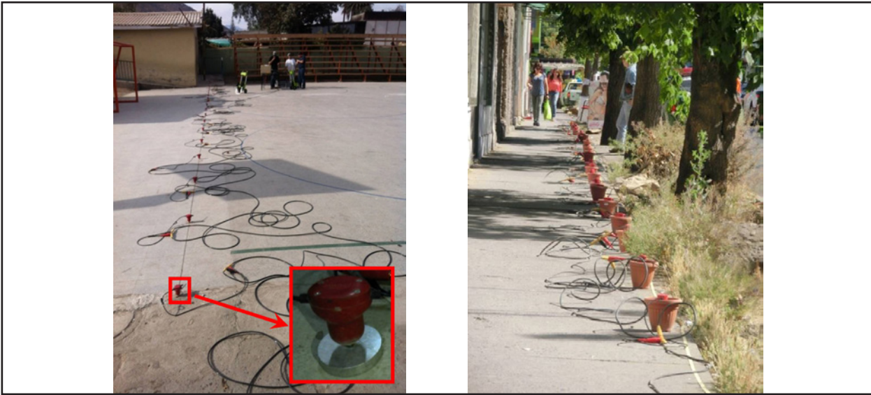
Figura 5.6: Mediciones con geófonos sobre superficies rígidas: usando bases planas (izquierda) y enterrados en maceteros (derecha).
