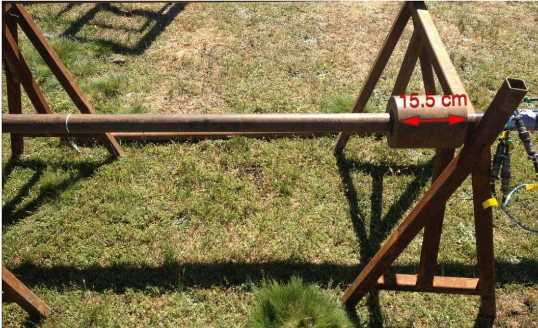
Fig. 4 – Equipo de SPT *Donut Hammer*, Cabeza de golpes
