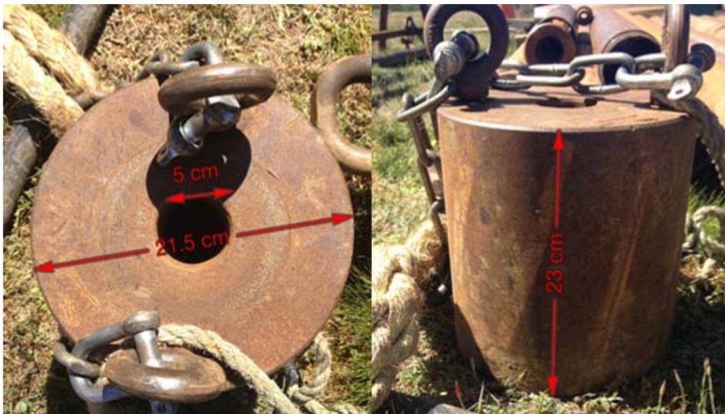
Fig. 5 - Equipo de SPT *Donut Hammer*, masa de 63,5 kg.
